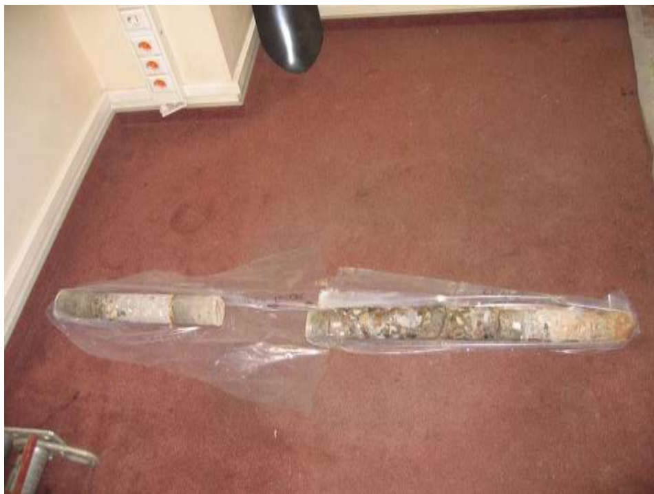
Фото 19. Вид керна, извлеченного из скважины-вскрытия СА-6. Разрыв между частями керна указывает на наличие песчаной подготовки мощностью 0,32м.
