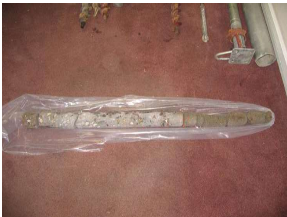
Фото 18. Вид керна из скважины-вскрытия СА-5.
